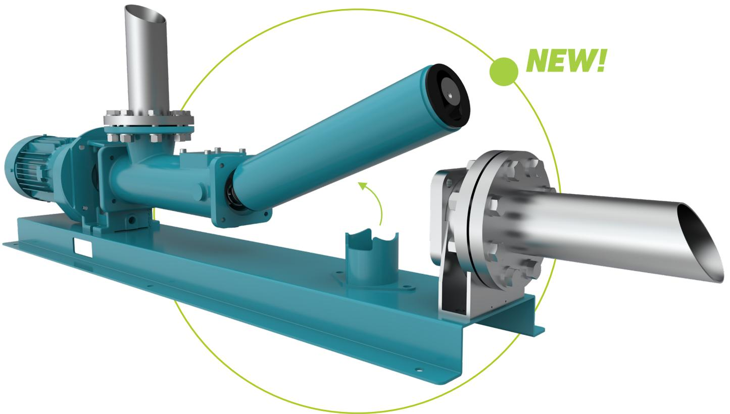
Replacement Option: Unser neuestes Modell ist die perfekte Lösung, wenn Raum und Zeit begrenzt ist. Der Wechsel des Rotors und des Stators erfordert nicht mehr den Ausbau aus der Rohrleitungen und die Demontage der gesamten Pumpe, was zu einer erheblichen Reduzierung des Zeit- und Wartungsaufwands führt.
